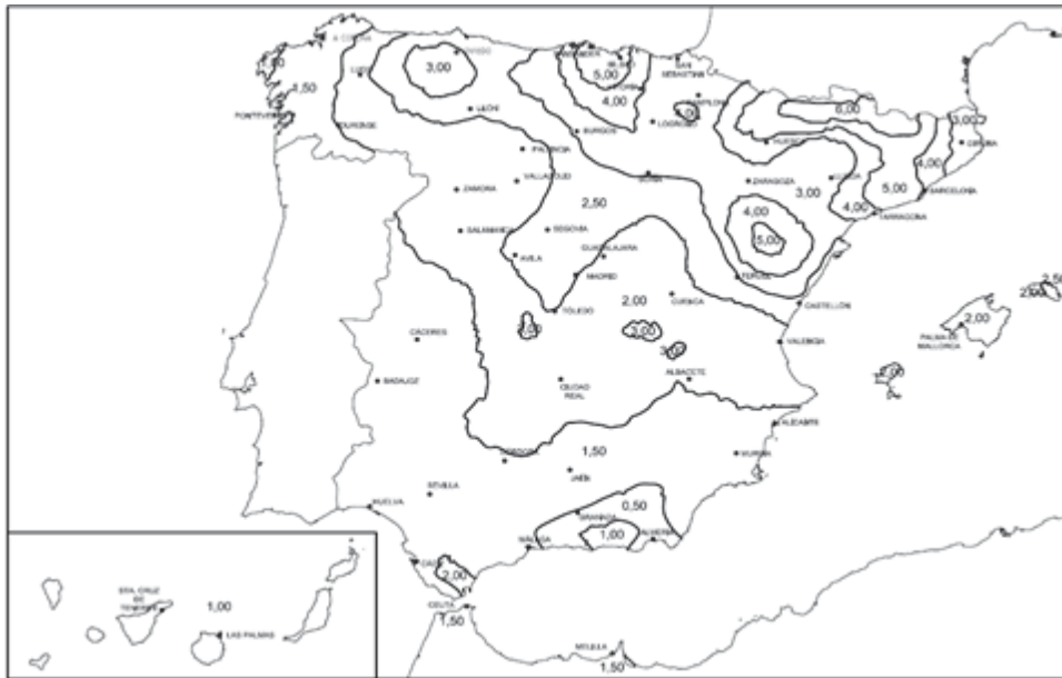
Figura 1: Mapa de densidad de impactos sobre el terreno (Figura 1.1 de la sección SUA 8 Seguridad frente al riesgo causado por la acción del rayo)
